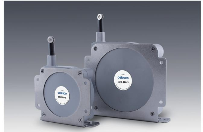
保護等級: IP67により屋外などの過酷な環境での使用に優れたSGDは4-20 mA (2線式) 又は 0-10 Vdcの出力を選択できる機能を持ち、計測範囲は0~2032mmと0-3048mmの2種類を提供します。
