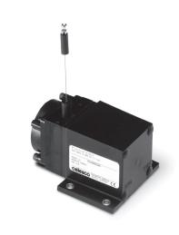
PT1DNはお使いのPLCにDeviceNET経由で繋がり、 0-51mm、0-1270mm内の正確な位置出力をフィドバックします。これは精密ポテンショメータを内蔵しているためで位置出力はアブソリュートで計測開始時にホーム位置へリセットする必要がありません。
