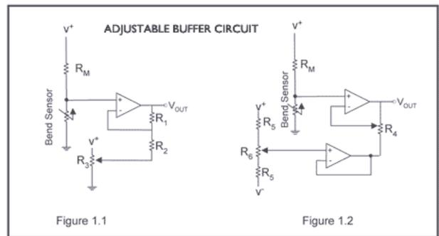
"偏差限界スイッチ - "アンプを使用し転化する入力電圧により出力が変化します。マイクロコントローラなしでスイッチとして曲げセンサーが使用出来ます"
